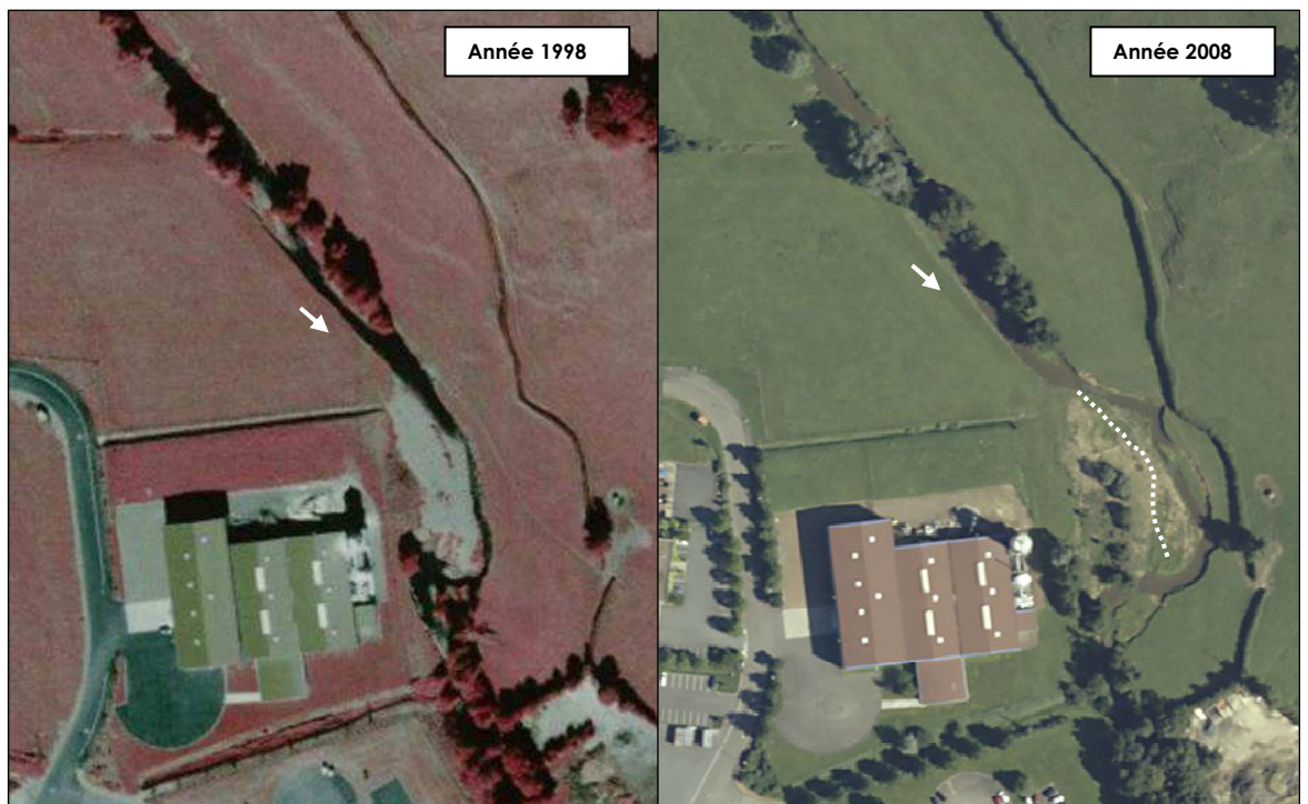
Figure 3-4 Illustration de la progression du lit du Bezo vers l'Est sur une décennie (1998-2008) par engraissement de la rive convexe (l'intrados du méandre) puis l'érosion de la rive concave (extrados du méandre) ; évolution ayant débuté dès le début des années 1980, soit à la suite immédiate des travaux de chenalisation de la rivière menés en aval de la route départementale n°487 - Sources : géoportail.fr & IGN.
