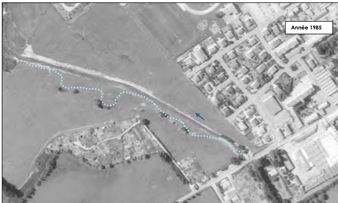
Figure 3-5 Vues aériennes comparatives du tracé du lit du Bezo entre 1954 (physionomie naturelle particulièrement sinueuse – image haute) et 1985 (lit de tracé rectiligne et uniforme - image basse, avec projection de l'ancien tracé) - Sources : géoportail.fr & IGN.
