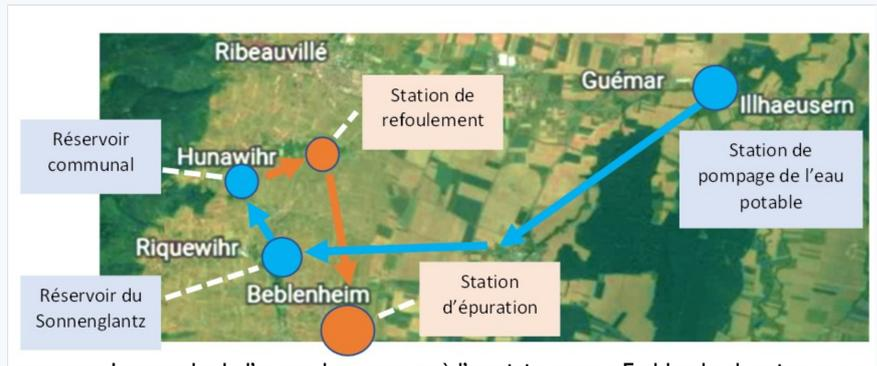
Le « cycle de l'eau » du pompage à l'assainissement. En bleu le cheminement de l'eau potable, en orange, celui des eaux usées.
