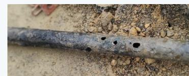
Réparation d'une fuite rue du Luehrert (2022) : remplacement de la canalisation métallique trouée, par un matériau polymère.
