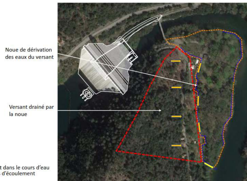
Figure 20 : Versant drainé par la noue de dérivation
