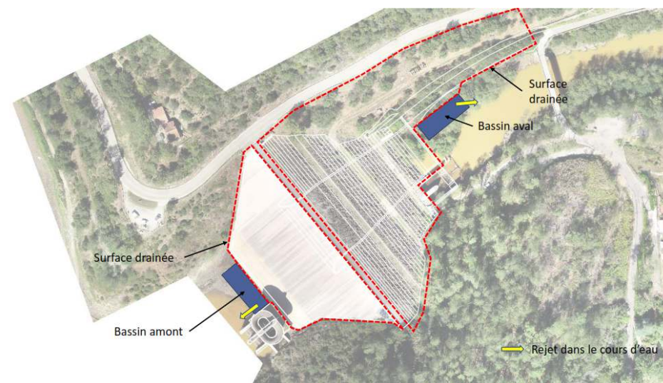
Figure 18 : Implantation des bassins sur le site du barrage de Sainte-Cécile-d'Andorge et surface drainée
