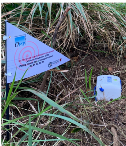
Matériel de la nappe à 7 km (nodes SmartSolo)
