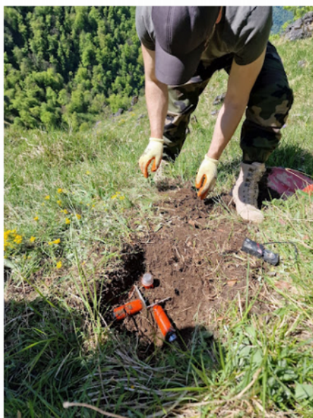
Matériel de la nappe dense (nodes Stryde)
