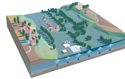
inondation de nappe
