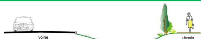
Noue en bordure de voie
