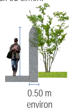
Mur de pierres sèches de Pays. Couronnement du mur en tuile tige de botte pour les murs hauts. Joints creux ou ciment
