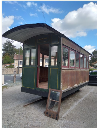
Cette voiture du tramway départemental est visible à la gare de Latillé (photo le 28 avril 2024). Elle accueillait 18 passagers, + 6 sur la plateforme (manquante ici)
