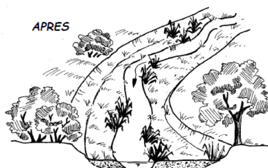
Création d'un lit mineur d'étiage avec des banquettes végétalisées puis colonisées par des plantes semi-aquatiques
