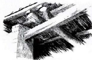
Charpente de peuplier et lit de roseaux.
