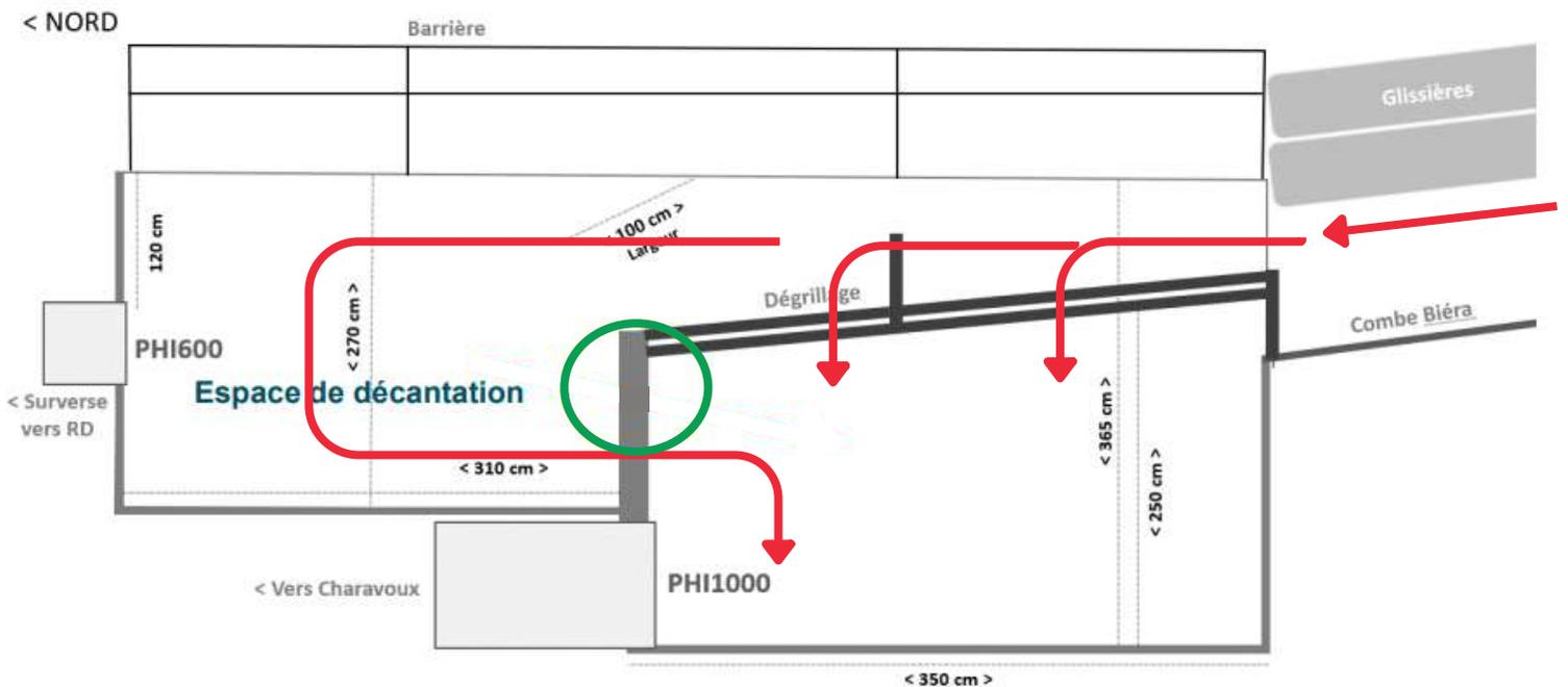
Les flèches rouges représentent le sens de déversement de l'eau dans l'ouvrage
