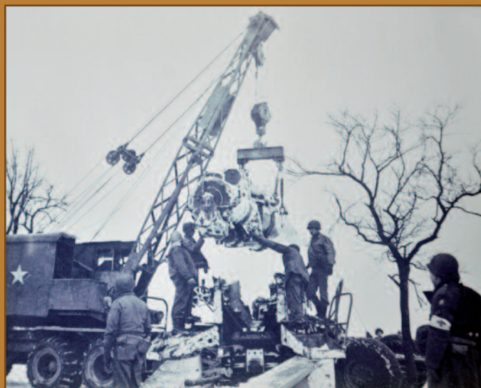
Camion grue du 243 ème Bataillon d'Artillerie américain en action. Montage d'un canon à longue portée (32km) M1-203 mm (8 pouces), destiné au siège de Metz. (coll. Ville de Rombas)
