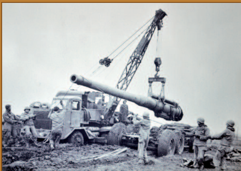
Camion grue du 243 ème Bataillon d'Artillerie américain en action. Montage d'un canon à longue portée (32km) M1-203 mm (8 pouces), destiné au siège de Metz. (coll. Ville de Rombas)
