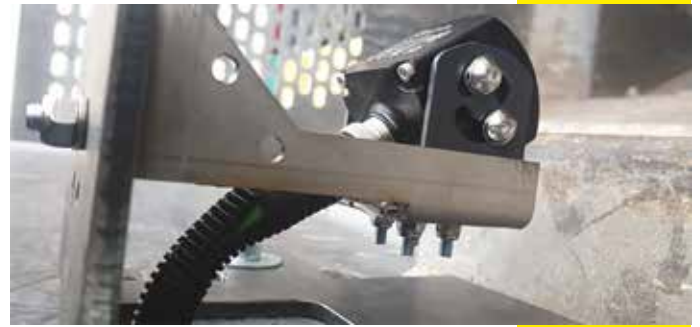
Caméra à l'intérieur de la trémie de l'Evolupac
