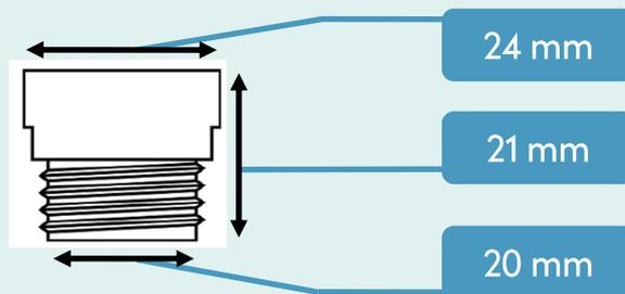
Équipement limité à 2 unités/foyer - Fourni avec joint d'étanchéité. Caractéristiques techniques: Compatibilité universelle (filetage 15x21mm) vissage facile sur tous les flexibles (standard 1/2) - Débit (entre 2,5 et 5 Bar): 6 ou 8 L/min - Pression minimale requise: 0,8 bars en sortie de robinet - Dimensions: H 21 x Ø 24 mm - Poids: 24 g - Certifications: ACS et CE - Garantie fournisseur: 2 ans
