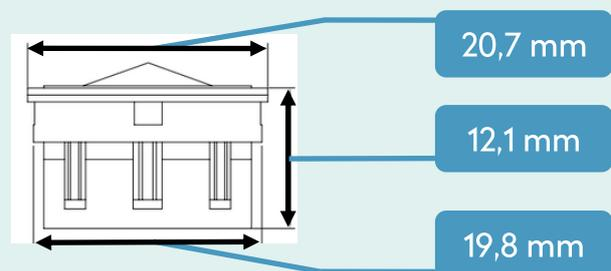
Équipement limité à 4 unités/foyer - Fourni avec joint d'étanchéité M24 ou F22. Caractéristiques techniques: Compatibilité, insertion facile dans toutes les bagues rondes standard - Débit (entre 2,5 et 5 Bar): Au choix de 4, ou 6 L/min - Pression minimale requise: 0,8 bars en sortie de robinet - Dimensions: H 12,1 mm x Ø 20,7 mm - Poids: 2 g - Certifications: ACS et CE - Garantie fournisseur: 2 ans
