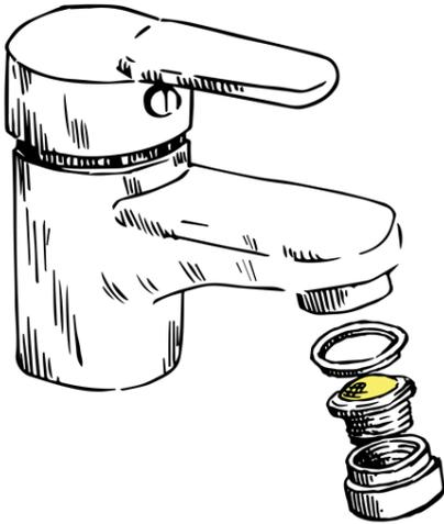
1. A l'aide d'une pince, dévissez la bague de la robinetterie; Nettoyez la à l'aide d'une brosse (tartre, accumulation de particules, ancien mousseur non économe, joint durci);
