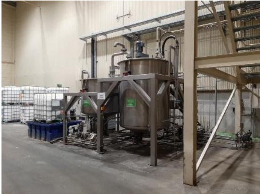
**Figure 36 : Equipement de préparation mélange siliconé pulvérisé au niveau de la fibérisation laine blanc**
