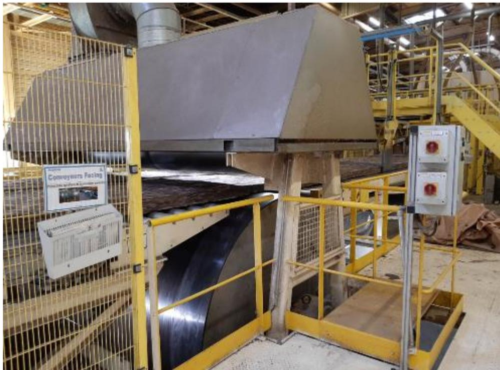
Figure 27 : Rouleau chauffant permettant l'application d'un revêtement
