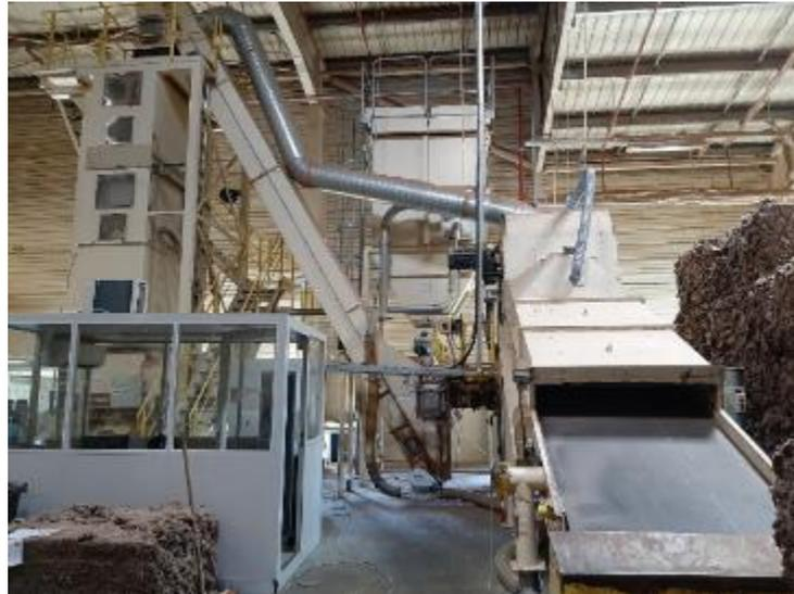
Figure 43 : Broyeur de la Thermo 46 et colonne d'ensachage
