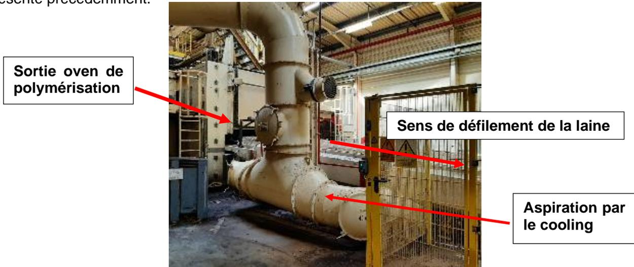
Figure 23 : Zone de refroidissement du matelas en sortie de l'étuve
