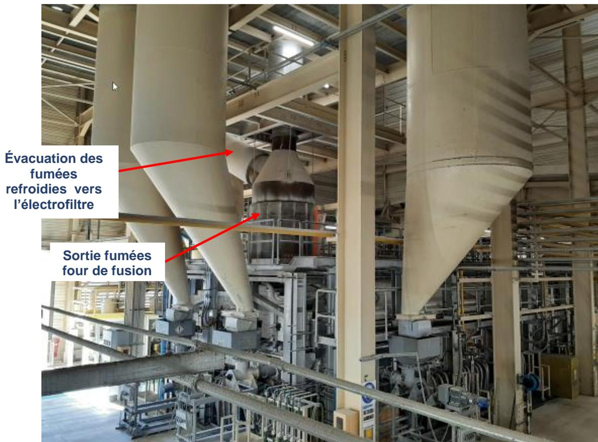
Figure 10 : Refroidissement des fumées
