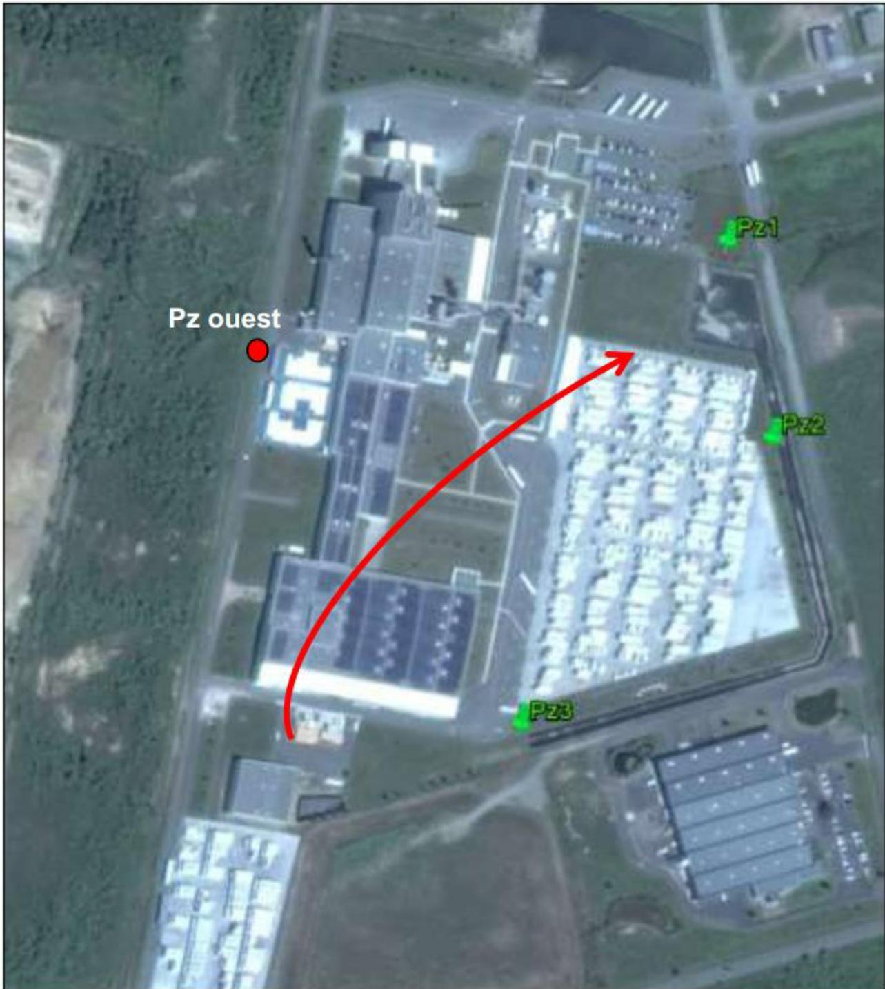
Figure 17 : Localisation des piézomètres prélevés et du sens d'écoulement des eaux souterraines (source : rapport PSI)
