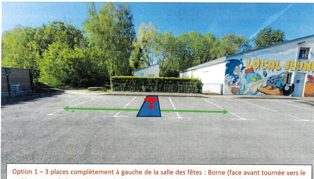
Option 1 – 3 places complètement à gauche de la salle des fêtes : Borne (face avant tournée vers le parking, et protégée par 2 arceaux) alimentant 2 places aux dimensions PMR (2x 3,3m de large) avec un couloir central de 0,9m (soit l'équivalent de 3 places classiques - Emprise ~ 38m<sup>2</sup>).
