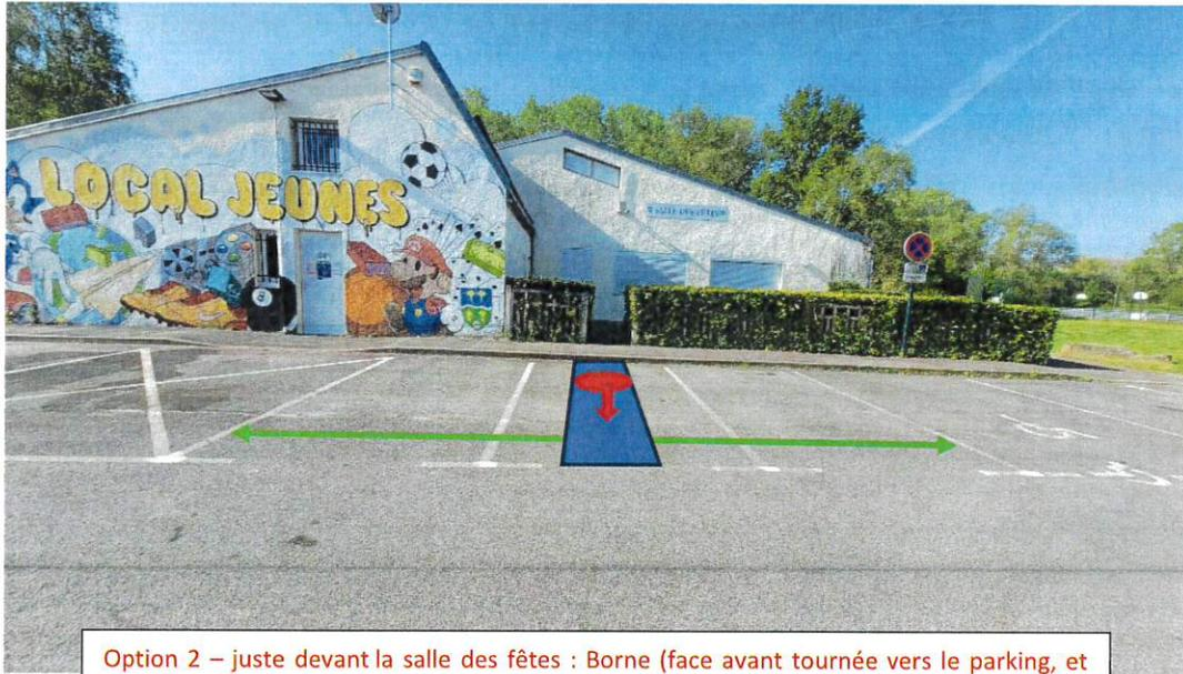
Option 2 – juste devant la salle des fêtes : Borne (face avant tournée vers le parking, et protégée par 2 arceaux) alimentant 2 places aux dimensions PMR (2x 3,3m de large) avec un couloir central de 0,9m (soit l'équivalent de 3 places classiques - Emprise ~ 38m²). Borne à écarter de 80cm mini de la bordure du trottoir.
