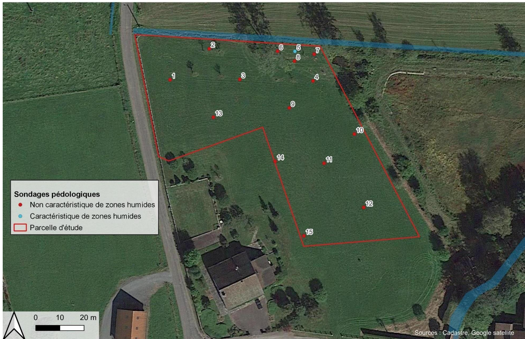
Sondages pédologiques réalisés sur la parcelle d'étude – Source : IAD.
