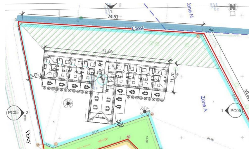
Figure 53 : Plan du projet après mesure d'évitement du fossé.
