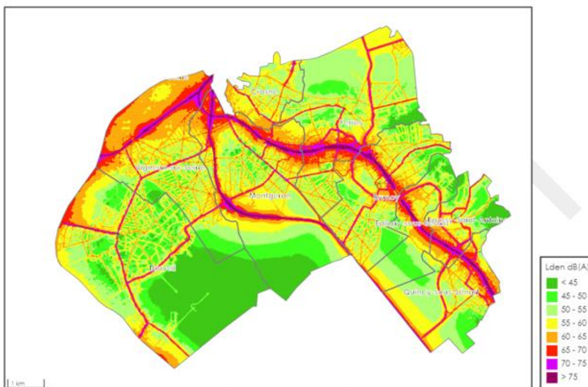
Figure 15 : Cartes de bruit de bruit cumulé des transports – C.A. Val d'Yerres Val de Seine
