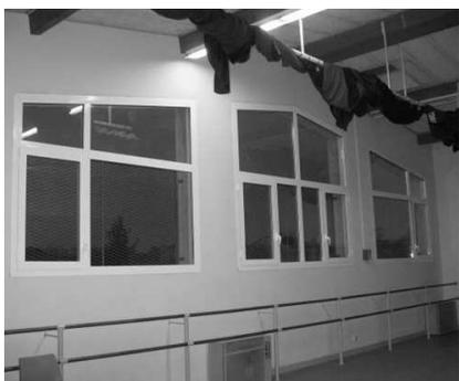
L'entreprise MDS a déposé les fenêtres devenues vétustes positionnées côté sud dans l'extension de la salle polyvalente pour mettre en place trois nouvelles ouvertures dotées de châssis aluminium et double vitrage. Après le changement de la porte d'issue de secours, ces travaux vont améliorer l'isolation thermique de cette salle régulièrement utilisée par les associations de Marssac.
