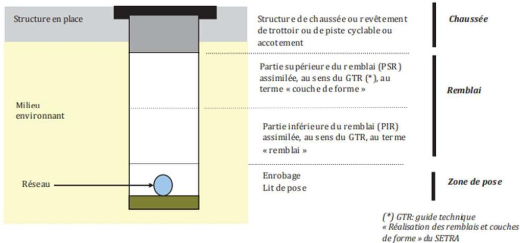
La profondeur, la largeur, la dimension du réseau le compactage et la reprise de la couche de surface doit être conforme aux règles · NF P 98-331, · NF P 98-332, · NF P 98-082, · NF P 18-545, NF EN 13 285.
