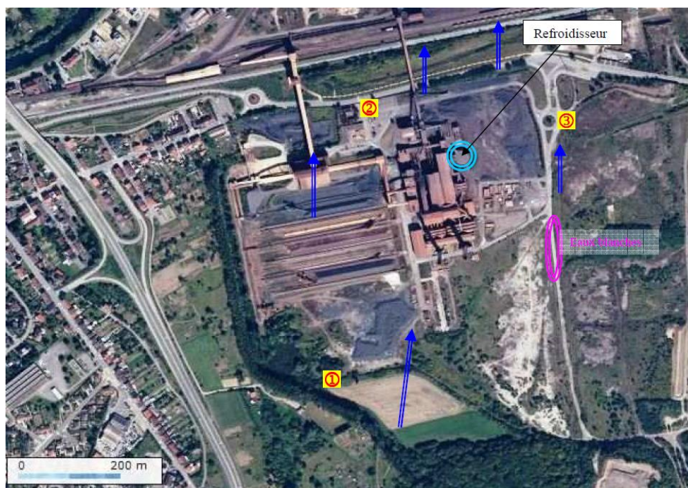
Figure 17 Localisation des piézomètres (carrés jaunes) source : PW Environnement « Diagnostic de la qualité des sols – Site de l'usine d'agglomération de Rombas (57) », août 2022.
