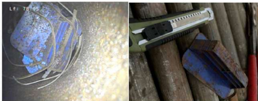
Figure 2 : Centreurs présents dans le forage
