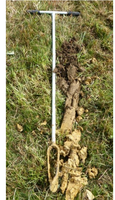
Sondage pédologique à la tarière à mains
