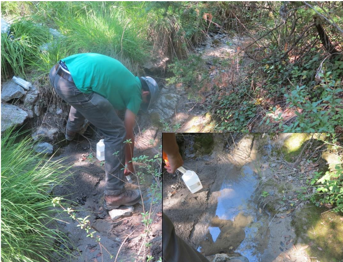
Figure 49 : Vue de l'échantillon ESUg_001 prélevé au pied de la digue de stériles dans un cours d'eau quasi-stagnant
