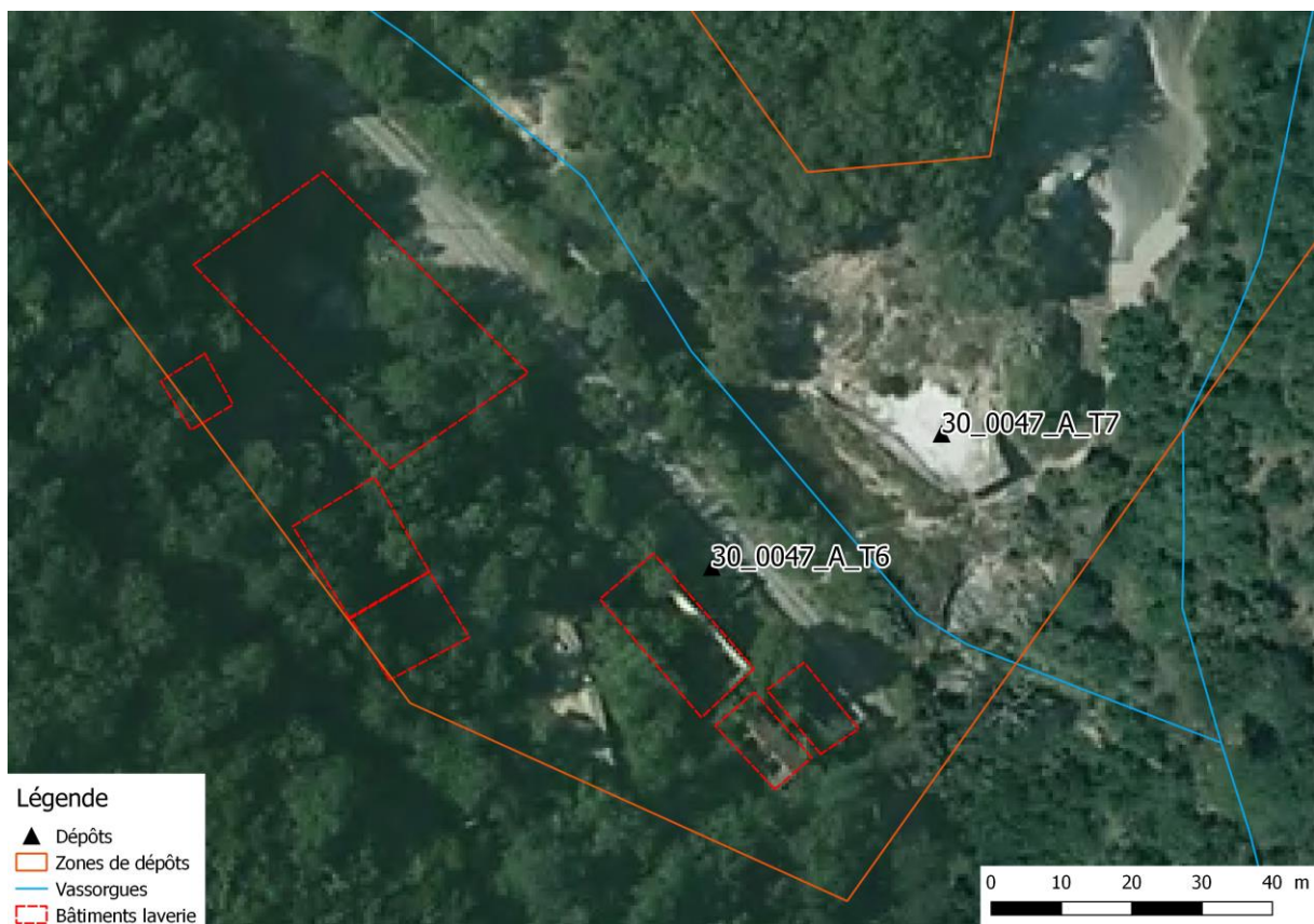
Figure 80 : Localisation des anciens bâtiments de la laverie et des anciens bassins de décantation sur le site de Lacoste
