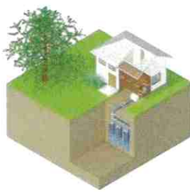
Pompe à chaleur sur corbeilles géothermiques
