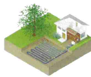
Pompe à chaleur sur capteurs enterrés horizontaux
