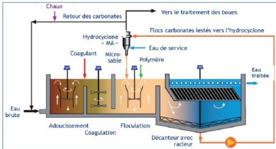
**Ce procédé breveté, compact et flexible a déjà fait ses preuves pour des opérations aux phasages complexes.** Il garantit l'élimination d'une forte turbidité de l'eau brute avec la décarbonatation, tout en fonctionnant à une vitesse au miroir proche de **55 m/h**.
