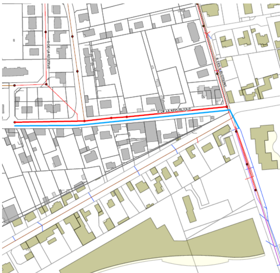
Figure 21 : Mise en séparatif Rue de la République dir. Est
