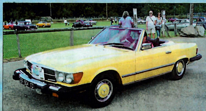
▲ Ce cabriolet Mercedes-Benz 450 SL est un modèle américain repérable à ses pare-chocs à absorption d'énergie proéminents et quatre phares ronds, les "sealed beams". Ces derniers étaient communs à tous les modèles proposés sur le marché américain.
