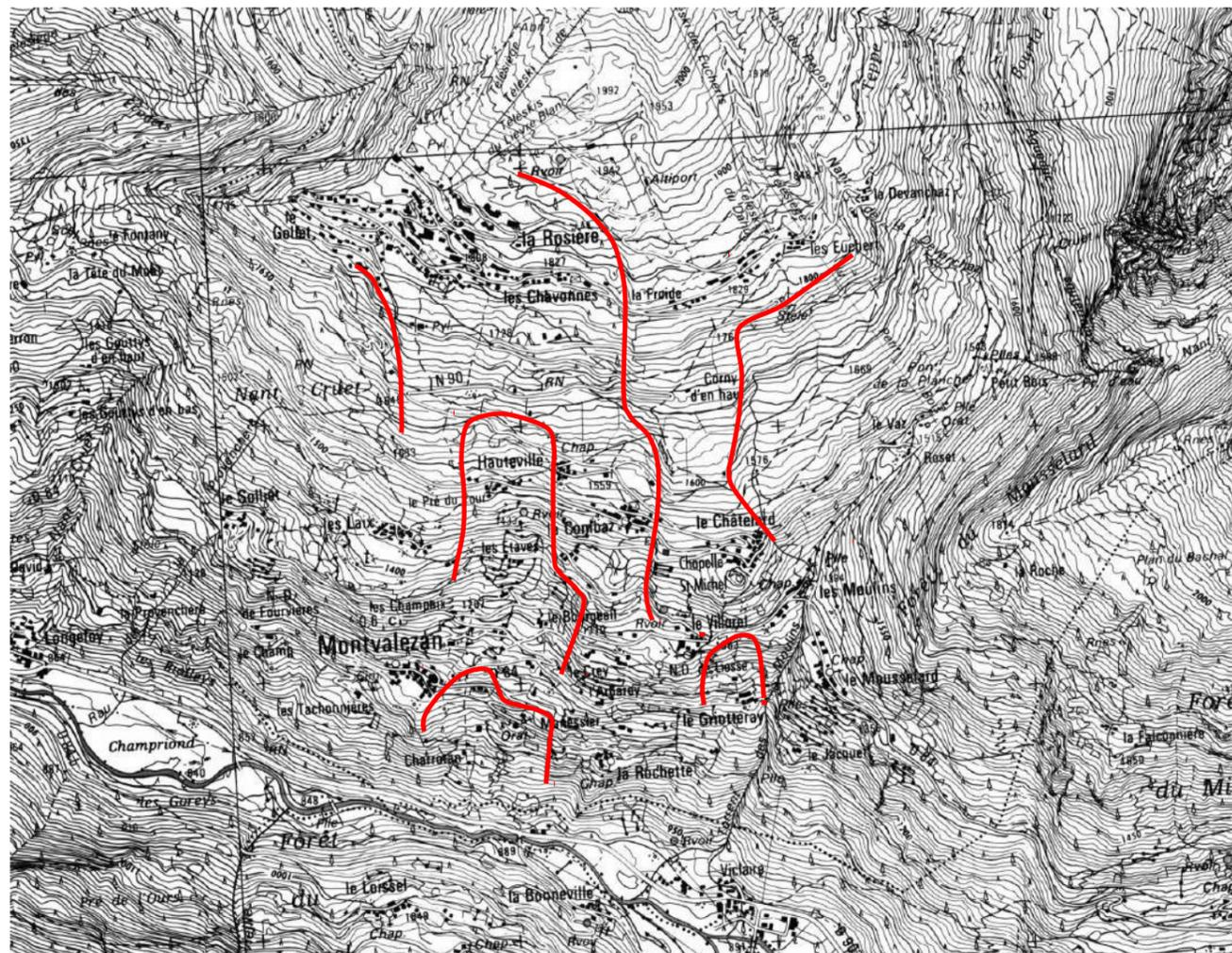
En partie centrale du versant, on distingue trois décrochements emboîtés, générant des masses glissées de plus en plus raides de l'amont vers l'aval. Les lignes de rupture sont souvent marquées par des affleurements de grès ou schistes gréseux très fracturés, d'où peuvent se produire quelques chutes de blocs. A l'inverse, au sein des masses glissées, on n'observe pas de roche en place mais essentiellement des formations superficielles meubles, comme la moraine argileuse.
