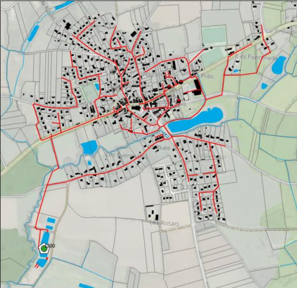
Figure 17 : Plan des réseaux d'eaux usées
