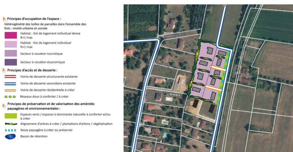
Figure 3: Exemple d'OAP prévoyant la création d'une noue paysagère le long de la voirie.
