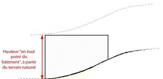
Définition de la hauteur maximale d'une construction au sens du Code de l'Urbanisme
