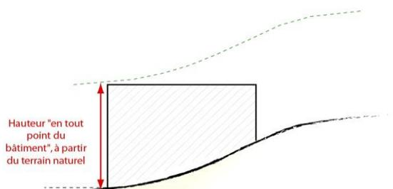
Définition de la hauteur maximale d'une construction au sens du Code de l'Urbanisme
