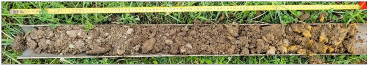
Photo 17 : Profil pédologique d'un BRUNISOL transformé graveleux, à matrice limoneuse dominante et à horizon cailloutique de surface. (Sondage P8) - Photo prise sur site, © Rainette, 2024.
