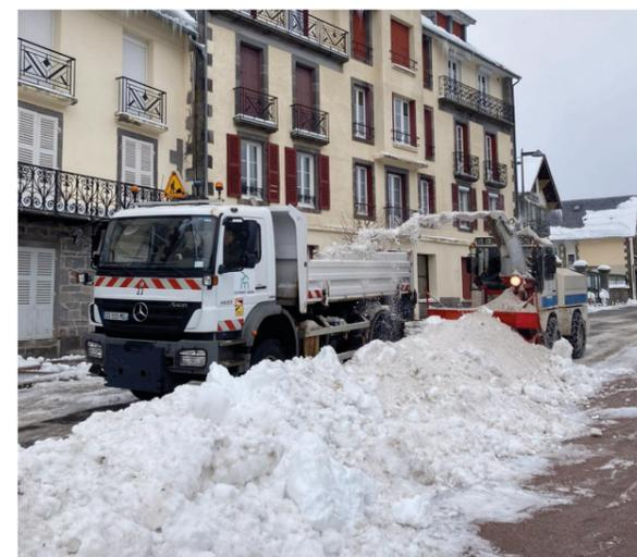
Cette mission est complexe et nécessite des moyens importants (humains et matériels) soit deux équipes d'une dizaine de personnes en astreinte de 4 h à 22 h, un chasse-neige, une chargeuse, un tractopelle, deux camions dont un équipé d'une saieuse, une fraise à neige, un tracteur et un mini-tracteur dédié aux trottoirs et ruelles.
