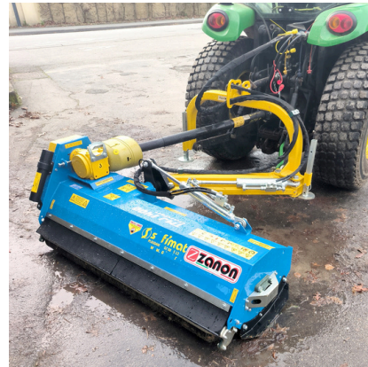
Le nouveau broyeur d'accotement peut être couplé sur un tracteur du service technique.
