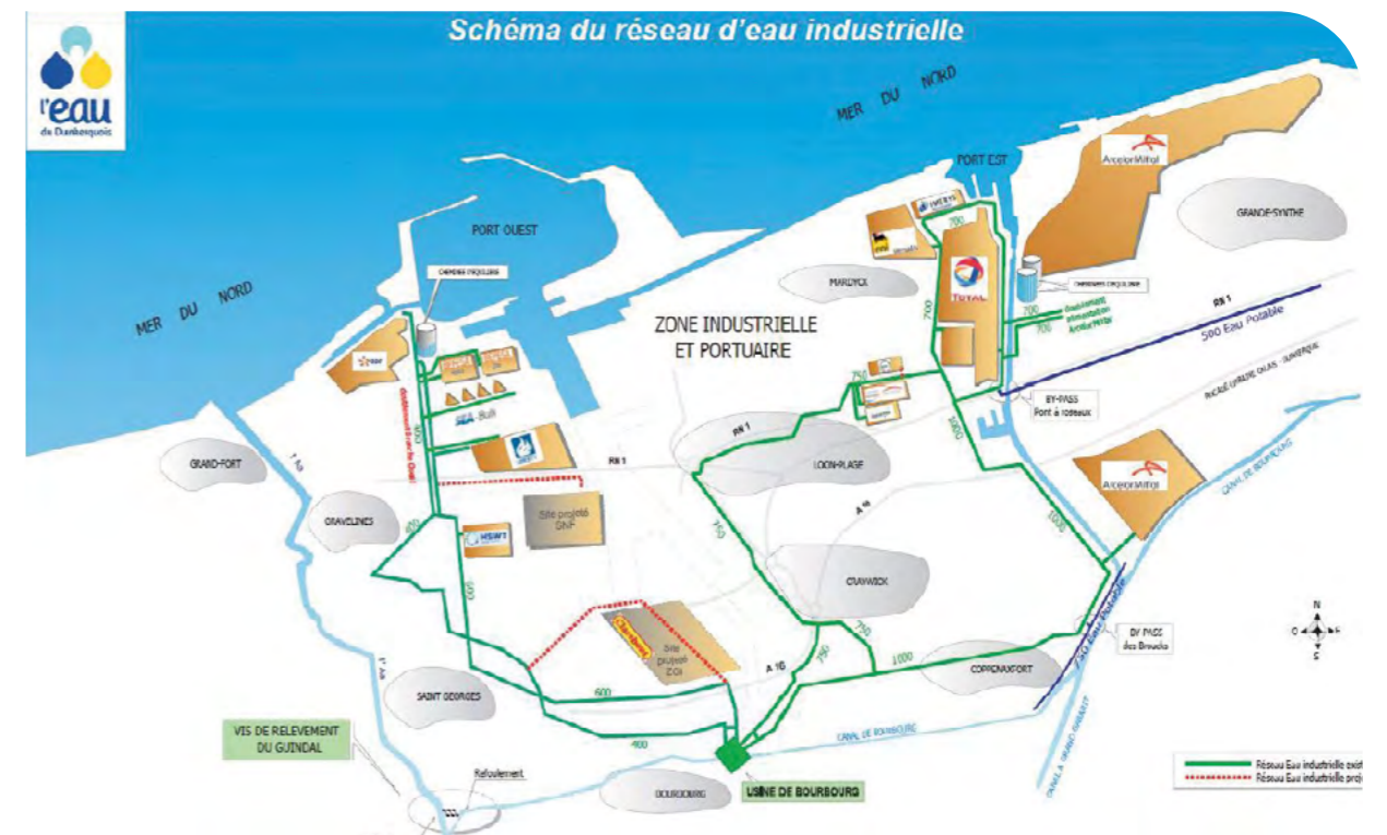
Schéma de distribution de l'Eau Industrielle
