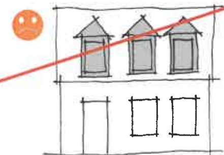
Éviter les lucarnes trop importantes par rapport aux volumes de toiture ou surdimensionnées.
