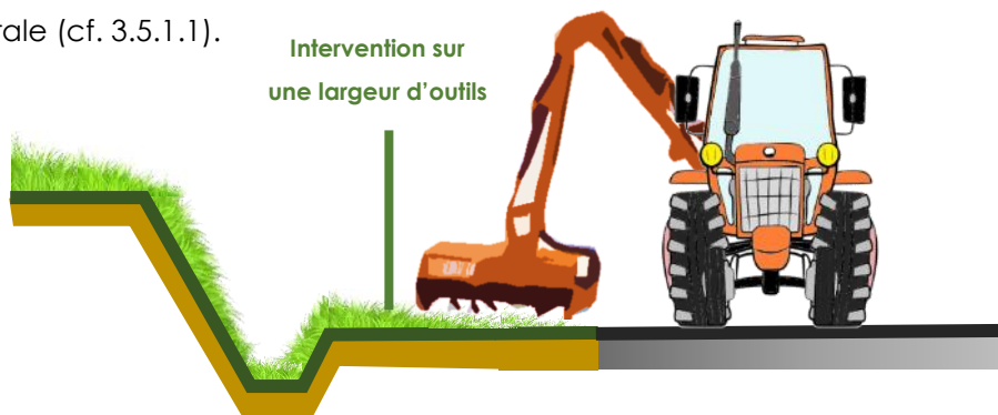
Figure 15 : Largeur d'intervention pour les accotements herbeux plats
