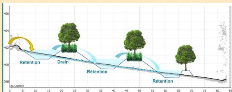
Vue en coupe du schéma de principe d'écoulement dans les cuvettes de rétention
