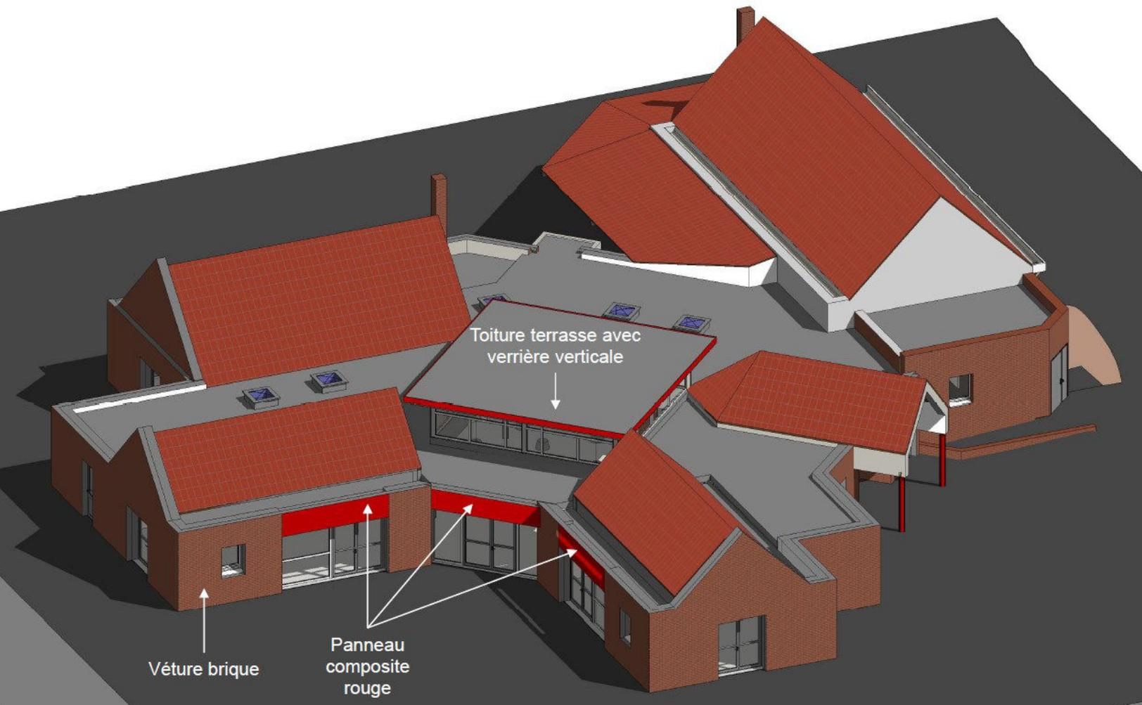
Le projet consistera au renforcement de l'isolation thermique par l'extérieur avec une vêtire en briques ce qui permettra une économie de chauffage l'hiver et de meilleures conditions de travail pendant les périodes chaudes.
