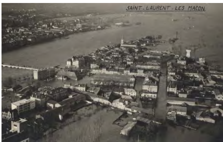
Saint-Laurent-sur-Saône – crue de janvier 1955 (crue de retour 70 ans, c'est-à-dire qui a une probabilité d'1/70 de se produire chaque année)
