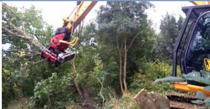
chenille équipée en huile hydraulique biodégradable munie d'un grappin coupeur (outil adapté permettant de maintenir, couper sélectivement ou élaguer les arbres à la hauteur voulue, en prenant soin de la végétation ou activité alentour), l'entreprise «SB paysage» a procédé à l'ouverture d'accès le long du domaine public fluvial, à la coupe et élagage de la ripisylve (végétation de bord de cours d'eau) ainsi qu'à la gestion des chablis (arbres en travers).
