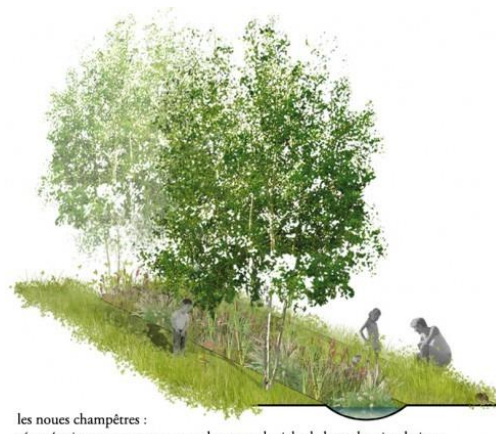
les noues champêtres : récupération et tamponnement des eaux pluviales le long des circulations
