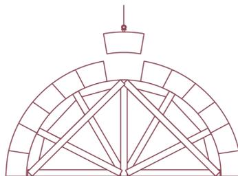
L'assemblage de pierres taillées permettaient aux Romains de construire des voûtes. À toi d'essayer d'en construire une !
