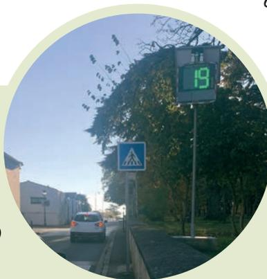
La commune s'est dotée de radars pédagogiques sur ses principaux axes. Ces radars enregistrent la vitesse des véhicules dans les deux sens de circulation.
