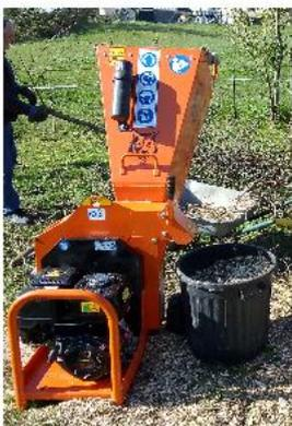
Pour broyer des branches de 7,5 cm de diamètre max, vous pouvez emprunter le broyeur thermique (équipement de sécurité et de transport fournis).
