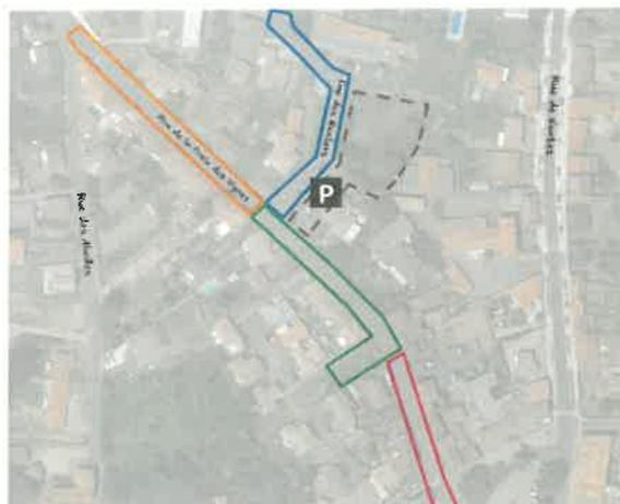
Figure 1 Emprise et phasage des travaux d'assainissement
