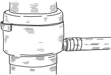
Pour raccorder votre Petite Cuve à votre gouttière, et ainsi récupérer les eaux pluviales de votre toiture, voici le **Collecteur de gouttière filtrant**, inclus dans le Lot « Petite Cuve ».
